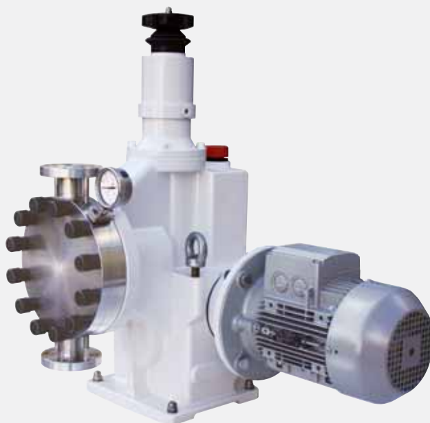
Bomba XL de simple membrana hidráulica con cabezal en PVDF. Regulación automática del caudal mediante servomotor eléctrico , diseñado por OBL, y con protección IP66. Incluye resistencia anticóndensación que le permite trabajar en ambientes difíciles como salino y/o áreas desérticas con altas variaciones de humedad y temperatura.
