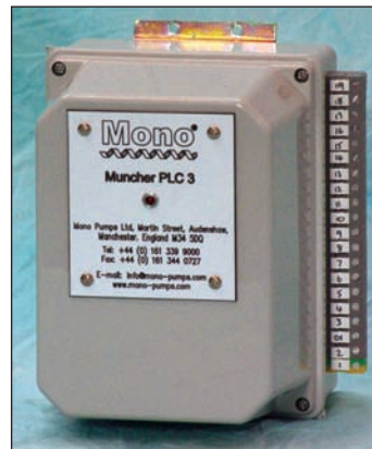
Típico PLC, para ser instalado en cuadro
